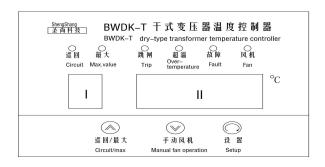
前面板上有两组数码管,Ⅰ数码管显示 A、B、C,Ⅱ数码管显示对应的该相温度。面板上排共 6 个指示灯。当"巡回"指示灯亮时,表示仪器巡回显示三相温度;当"最大值"指示灯亮时,表示仪器显示当前最大值温度及其对应相。"跳闸"、"超温"、"故障"、"风机"指示灯分别指示跳闸、超温、故障、风机的状态。
