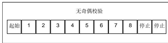
图 10: RTU 模式位序列 (无校验的特殊情况)
