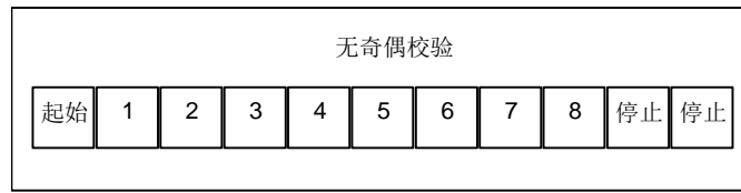
图 10: RTU 模式位序列 (无校验的特殊情况)
