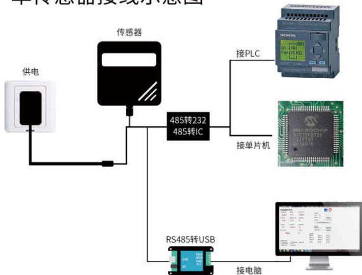
本产品也可以多个传感器组合在一条 485 总线使用，在进行 485 总线组合时请遵守“485 总线现场接线守则”（见附录）。理论上一条总线可以接 16 个以上的 485 传感器，如果需要接更多的 485 传感器，可以使用 485 中继器扩充更多的 485 设备，另一端接入带有 485 接口的 PLC、通过 485 接口芯片连接单片机，或者使用 USB 转 485 即可与电脑连接，使用我公司提供的传感器配置工具进行配置和测试。
