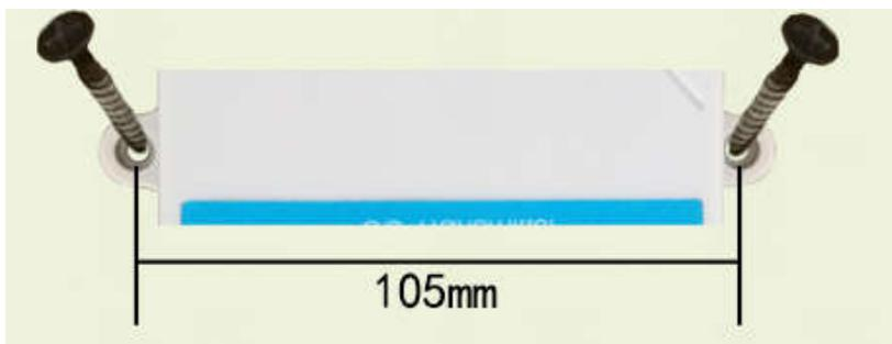
壁挂王子壳为壁挂式安装，安装孔位于设备两侧中部位置，安装孔径小于 4mm，孔距 105mm，可使用 3mm 的自攻螺丝安装。
