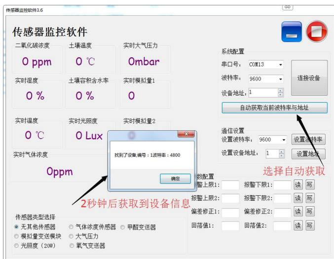
然后单击连接设备后即可实时获取传感器数据信息。如果您的设备是气体浓度传感器，则请在传感器类型处选择“气体浓度传感器”，甲醛传感器选择“甲醛变送器”，模拟量变送器选择“模拟量变送模块”，大气压传感器选择“大气压力传感器”，光照度传感器选择“光照度 20W”，氧气传感器选择“氧气变送器”，其他的传感器均选择默认的“无其他传感器”。
