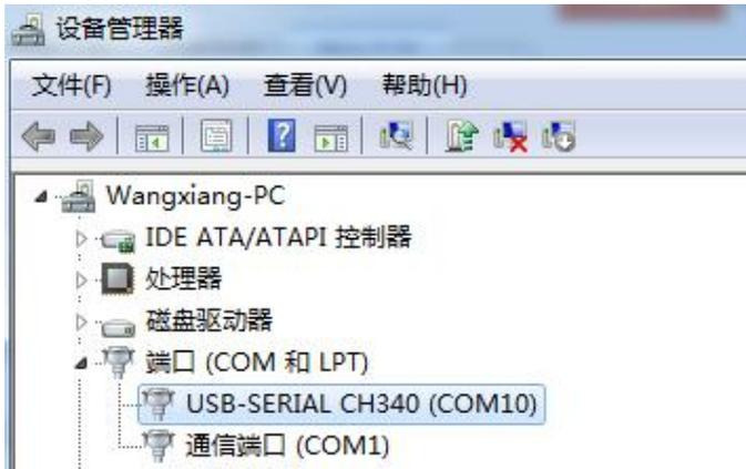
如上图所示，此时您的串口号为 COM10，请记住这个串口，需要在传感器监控软件中填入这个串口号。
