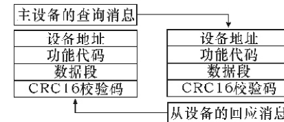
Modbus协议查询应答数据流
