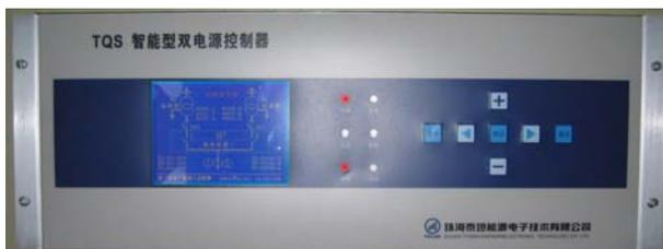
TQS 智能型双电源控制器，是双电源切换系统的核心控制部分，测量所有进出线的电量参数和状态量，完成系统的控制和人机接口功能。提供多种智能化工作模式可供用户选择。大屏幕液晶显示（320×240 液晶），全中文介面，操作简便，系统工况一目了然；采用交流采样，可监测进线和母线的电量参数（电压、电流、频率、功率、电度等）；
