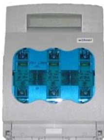
母线进线采用德国维纳尔熔断器式负荷隔离开关可带负荷分断，即可直接挂装在母线上，也可安装在固定板上。提供了上、下端输入输出结构，带刀口引入及灭弧装置，开关罩上带有自封闭的监测孔，内置信号开关监测开关盖的闭合，可选配熔丝监测器。
