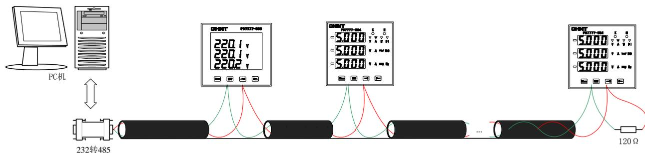
图 12 通讯连接示意图
