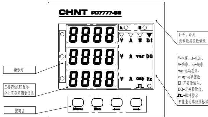
图 11 面板图 (以 PD666-8S4 为例)
