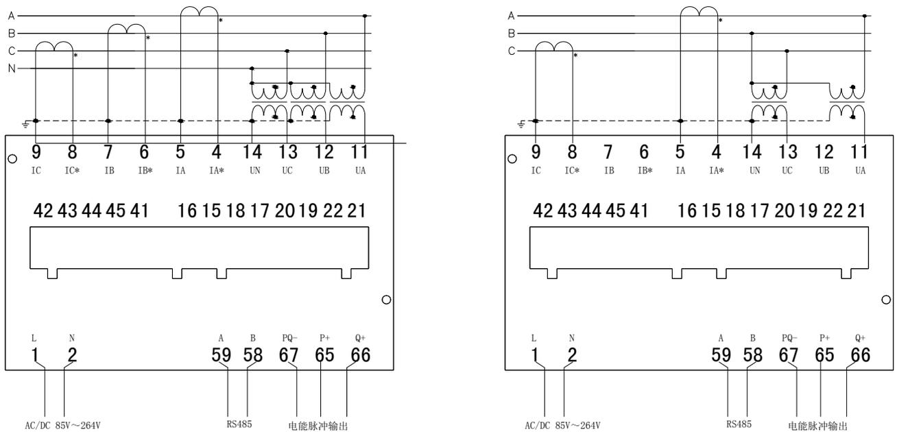
图 16 三相四线与三相三线电压经互感器输入、电流经互感器输入
