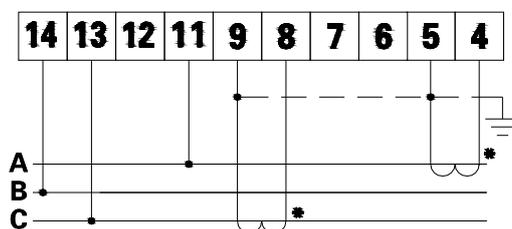
图 20 三相四线电压直接输入、电流经互感器输入
