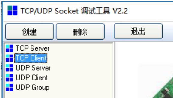
2、选中“TCP Client”，然后点击“创建”按钮，弹出如下对话框并正确输入设备的 IP 和设备监听的本地 TCP 端口号：
