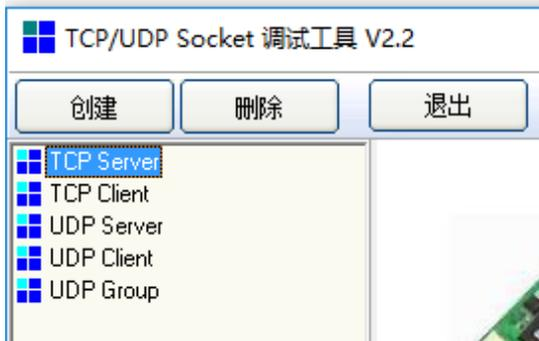
2、选中“TCP Server”，然后点击“创建”按钮，弹出如下对话框并正确输入设上位机软件 SocketTool 要监听的端口号：
