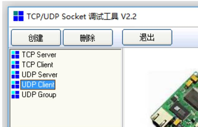
2、选中“UDP Client”，然后点击“创建”按钮，弹出如下对话框并正确输入设备的 IP 地址、UDP 端口号以及调试工具监听的本地端口号：
