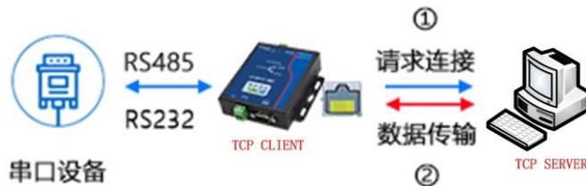
图 3.5 TCP CLIENT 模式工作原理
