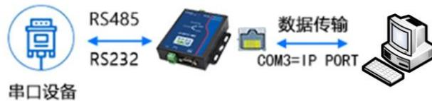
图 3.20 虚拟串口工作原理
