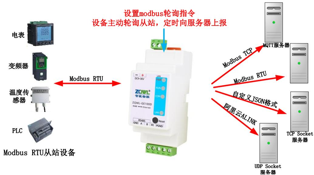
图 5.1 Modbus 主动轮询原理框图
