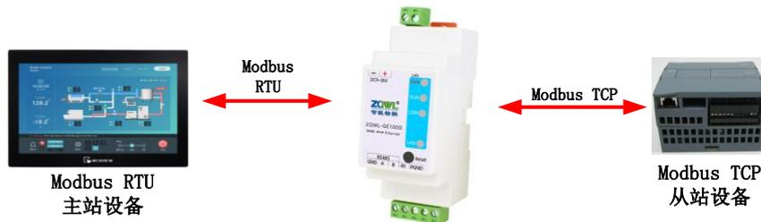
图 3.26 ModBus TCP/RTU 互转（主）模式应用框图
