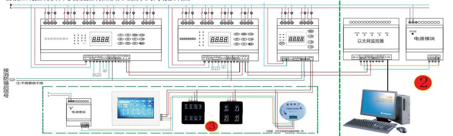
1. 不需要消防联动时，消防电源24V连接导线不接。
