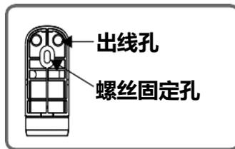
图8.光栅底座固定孔与出线孔图
