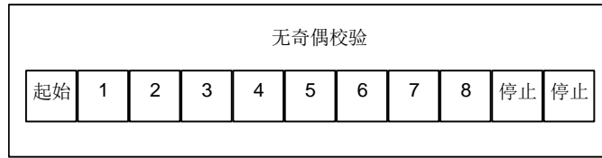
图 10: RTU 模式位序列 (无校验的特殊情况)
