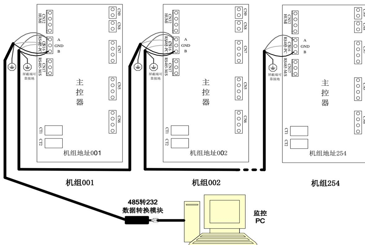
图 1 后台通信系统网络接线图
