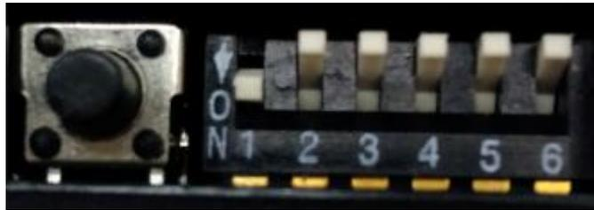
地址设置开关：通过设备上的播码开关可以设置设备的 485 地址，当开关往下拨到 ON 时开关生效。各开关拨到 ON 时表示的数值如下：
