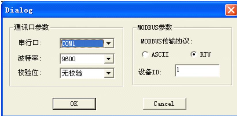
串行口：选择电脑用于连接触摸屏的 com 口，波特率：9600，校验位：无校验
