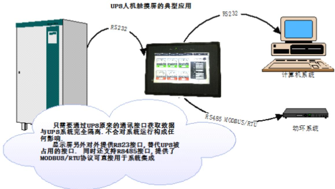
参考上图,一般应用中,该触控屏直接通过 RS232 和 UPS 主机通讯,触控屏直接安装在主机机箱上.. 触摸屏另外提供一个 RS232 接口,以替代被占用的通讯口! 同时该触控屏还支持 RS485 接口,并提供标准的 MODBUS RTU 协议.
