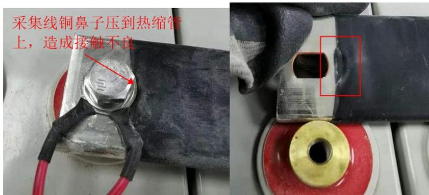
5) 螺栓要拧紧，不能松动，螺丝松动会造成接触不良，放电时候大电流只从小接触面流过，造成局部温度过高，存在安全隐患。
