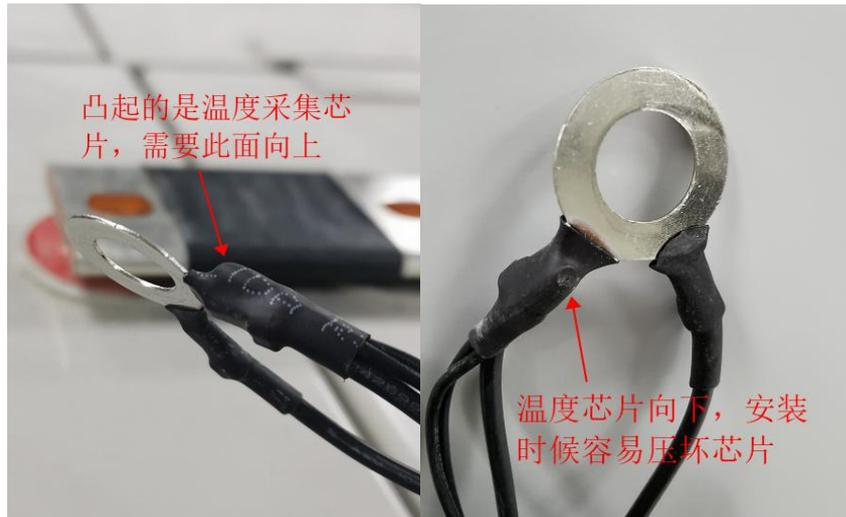
4) 如果电池连接片有热缩管套，电池采集线不能压到热缩管上，电池连接片也不能压到热缩管。
