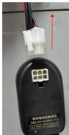
操作采集线前，需要拔掉采集线跟单体模块的连接
