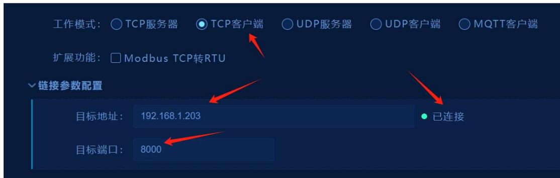
串口服务器作为 TCP Client，连接 IP 地址为 192.168.1.203 的 TCP Server 的 8000 端口
