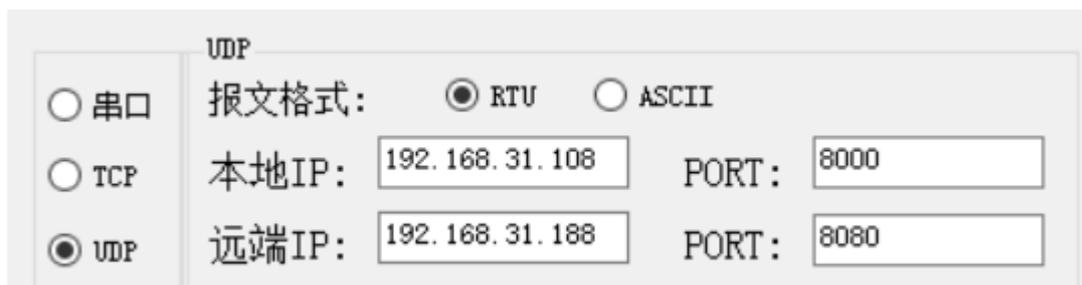
其中本地 IP 地址和 PORT 为调试管理软件所在的 PC 的 IP 地址和使用的端口号；远端 IP 和 PORT 为设备的 IP 地址和使用的端口号。
