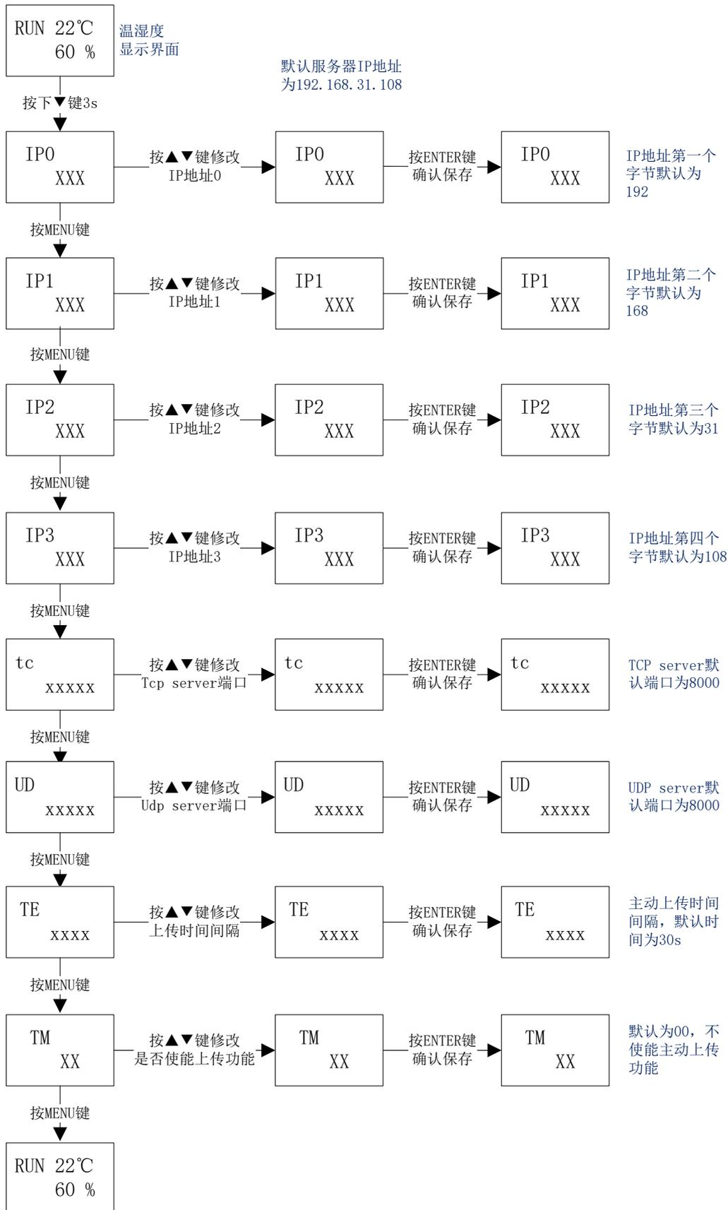
备注：1、远端 IP 是指服务器或者上位机软件对应的 IP 地址，一般在使能
