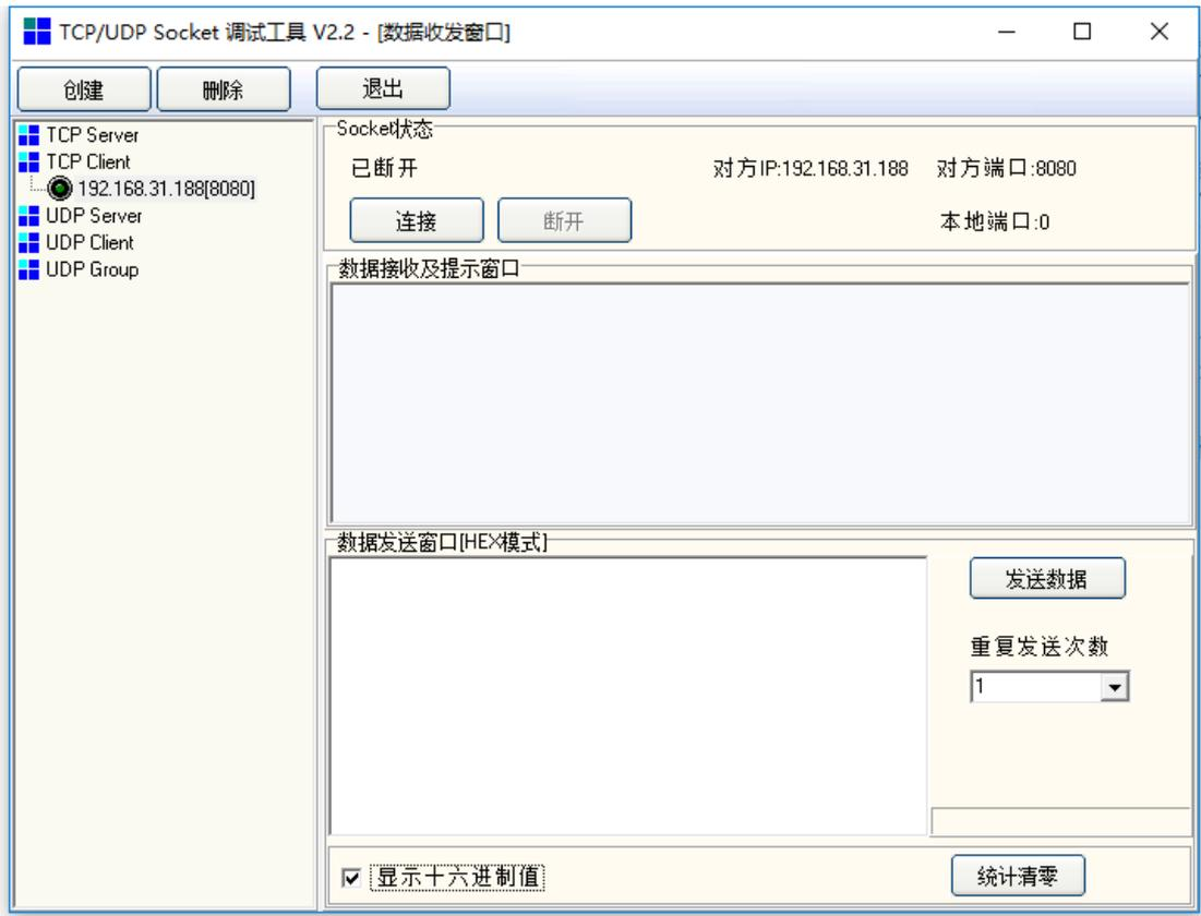
5、点击“连接”按钮，连接成功后会显示“已连接”
