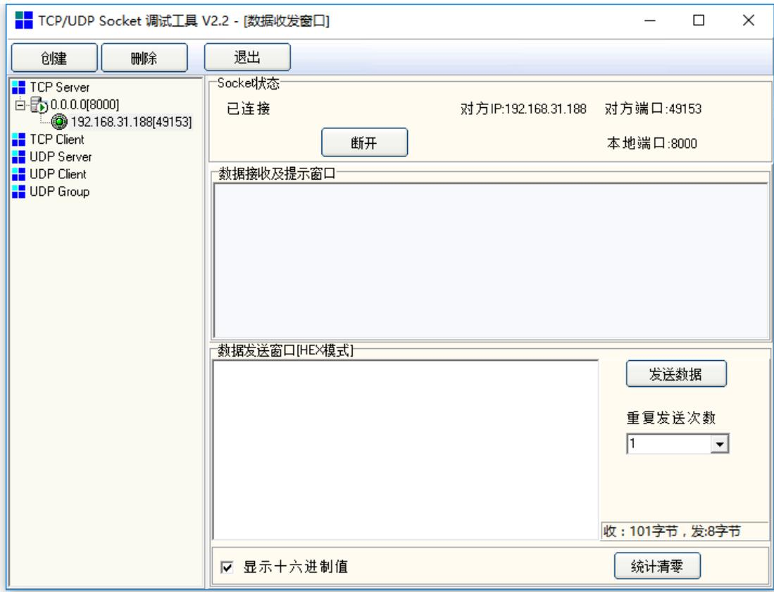
2、在数据发送窗口输入十六进制指令：010400000003B00B，表示读取设备的简易地址为 0x01，功能码 0x04，起始寄存器地址 0x0000，读取个数 0x0003，数据报文的 crc16 校验为 0xB00B，如下图：
