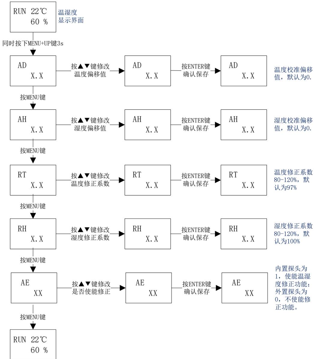
备注：对于温湿度修正系数，只有在内置探头版本才需要使能，使能后温度和湿度会根据设置的 RT 和 RH 百分比值自动修正当前测量的环境温度和湿度，具体需要设置的百分比修正值与设备所处的具体环境有关。
