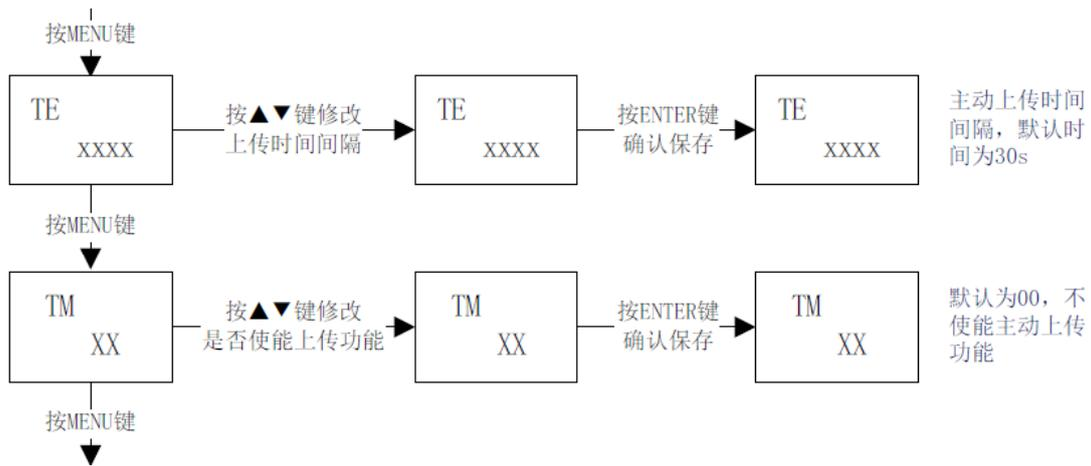
具体的修改步骤如下（参照说明书的 3.4 章节“远端服务器 IP 地址相关信息设置功能”）：
