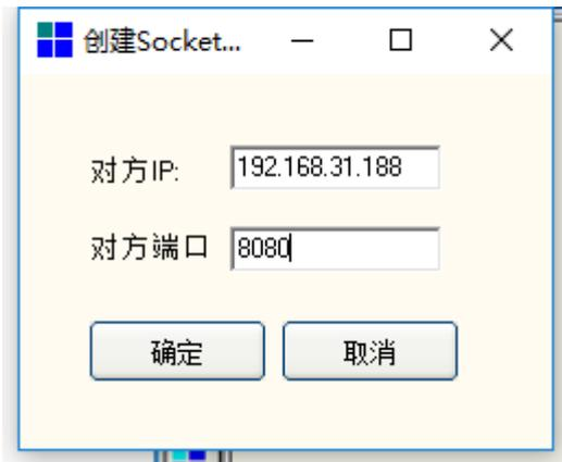
4、点击“确定”按钮，创建 TCP 链接并勾选上底部的“显示十六进制值”：
