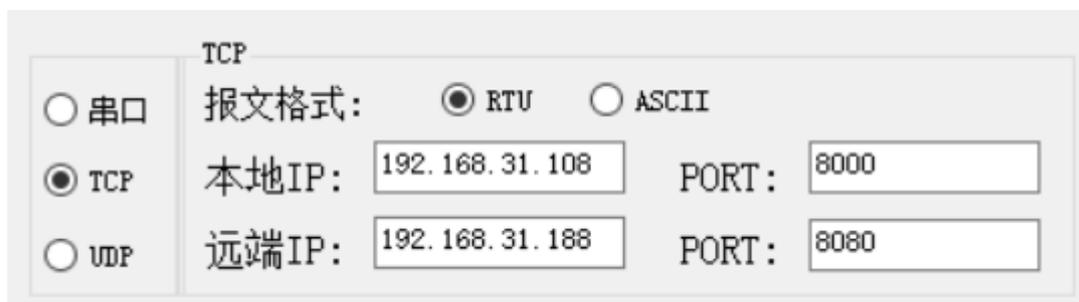
其中本地 IP 地址和 PORT 为调试管理软件所在的 PC 的 IP 地址和使用的端口号；远端 IP 和 PORT 为设备的 IP 地址和使用的端口号。
