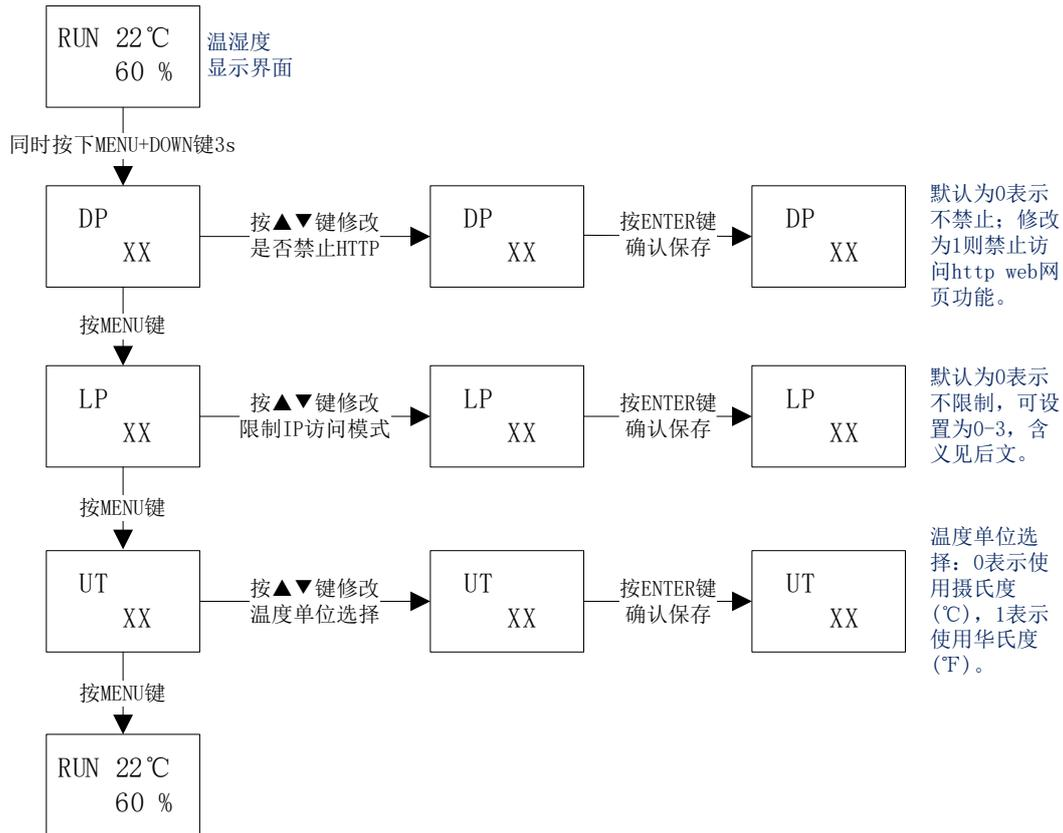
备注：1、限制 IP 访问 LP 的值可以设置为 0-3，具体含义为：0 表示不限制 IP 访问；1 表示只允许远端 IP 访问设备；2 表示禁止广播报文；3 表示只允许远端 IP 访问设备并禁止广播报文。
